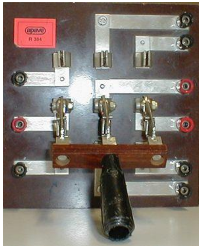
Commutateur triphasé. Protection des personnes inexistante. Des générations d'élèves ont pratiqué ce matériel totalement interdit d'utilisation aujourd'hui. (JP Chopin)
